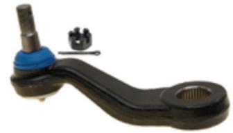
**LES BRAS DE RENVOI DE DIRECTION** sert de point de pivot avec la timonerie de direction de votre véhicule. Le bras de renvoi de direction est raccordé au côté opposé de la bielle d'accouplement à partir de la biellette pendante jusqu'au cadre du véhicule, pour supporter la bielle d'accouplement.
