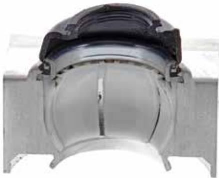
**CONCEPTION DE LA ROTULE** Les bagues de qualité d'origine utilisent un palier en plastique qui peut se déformer rapidement sous des forces de charge constantes. Cela pourrait entraîner une défaillance prématurée de la pièce.
